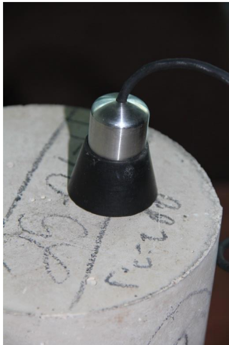
Figura 3.4. Hidrófono utilizado en la realización de la prueba. En la imagen se encuentra colocado sobre uno de los cilindros ensayados.
