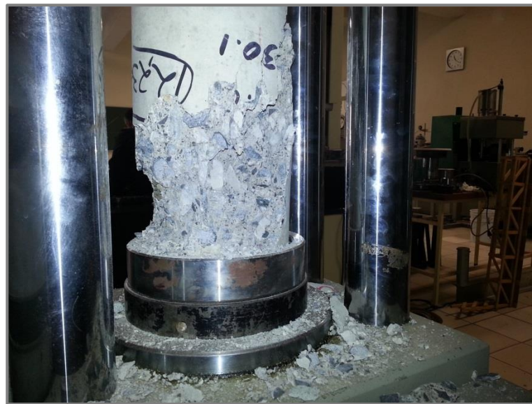
Figura 3.16. Falla de un cilindro ensayado por compresión.
