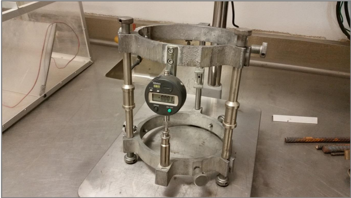
Figura 3.12. Anillos que se sujetan al cilindro de concreto conectados a un deformímetro para medir la deformación longitudinal.
