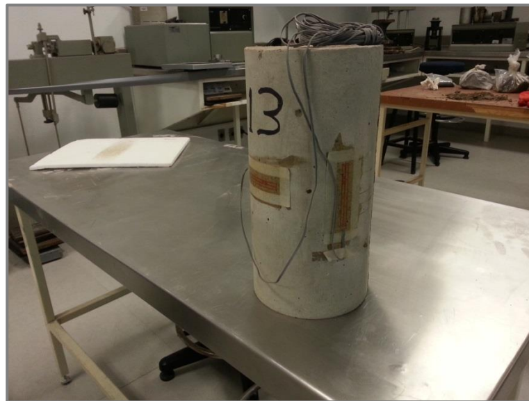
Figura 3.17. Cilindro ensayado con strain gauge colocados en su costado.
