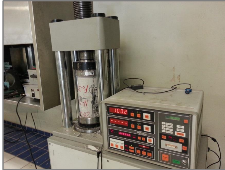
Figura 3.15. Otro de los cilindros ensayados ya llegado al punto de carga máxima.
