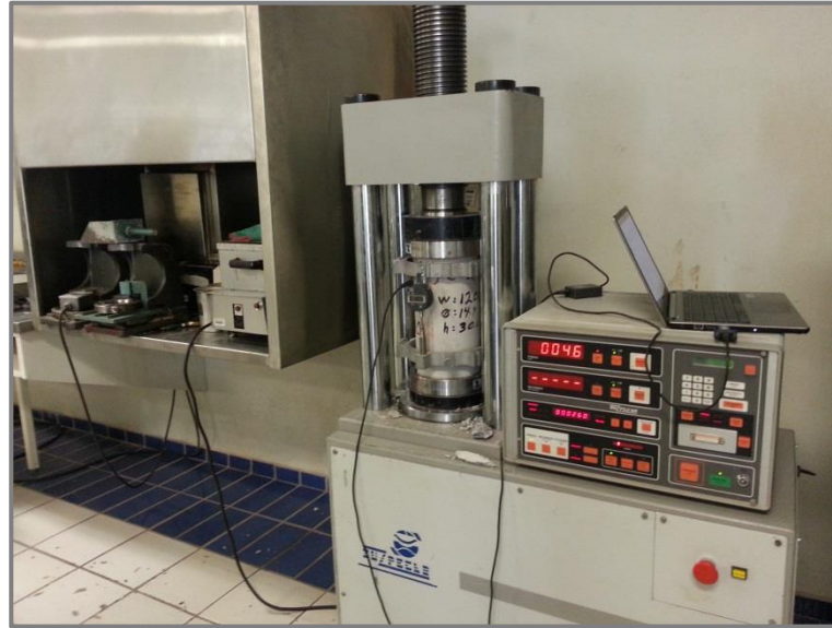
Figura 3.13. Prensa ensayando uno de los cilindros. Se puede observar los anillos con el deformimetro en funcionamiento.
