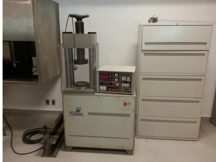
Figura 3.11. Prensa donde se ensayaron los cilindros para obtener su módulo elástico estático según la norma de la ASTM C 469 [2]
