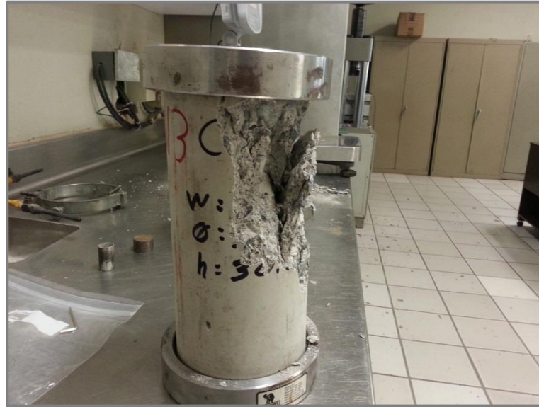
Figura 3.10. Espécimen ya ensayado donde se observan las bases utilizadas en sus caras extremas.
