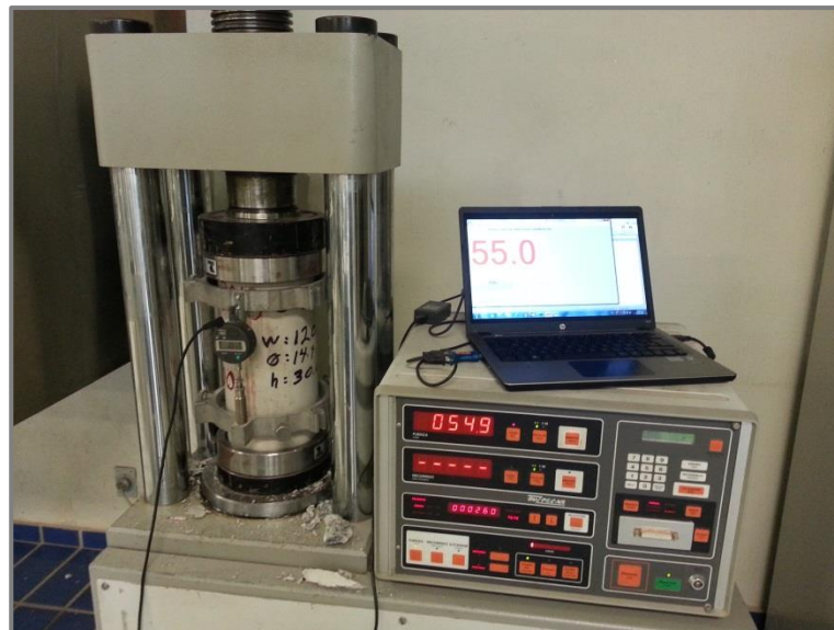
Figura 3.14. Uno de los ensayos realizados. Se observa la vinculación del computador con deformimetro y prensa.
