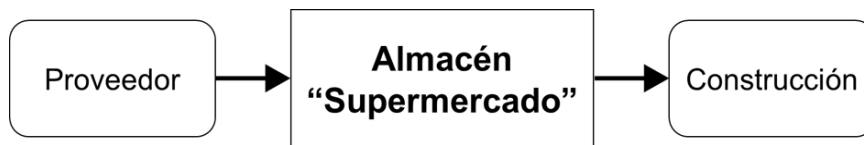
Figura 8 Supermercado en la construcción
