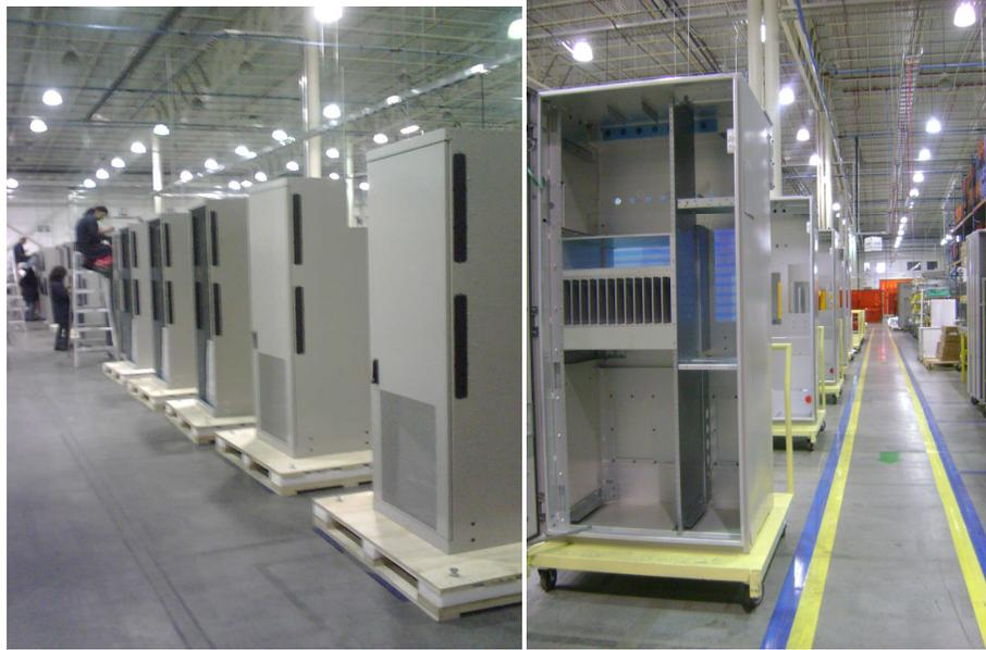
**Figura 51** – Flujo de una sola pieza integración de Racks de Aluminio
