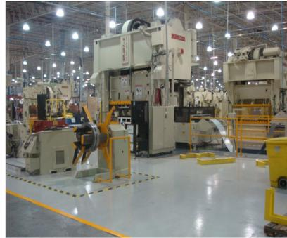
**Figura 45** – Cargado de MP en Prensas Hidráulicas
