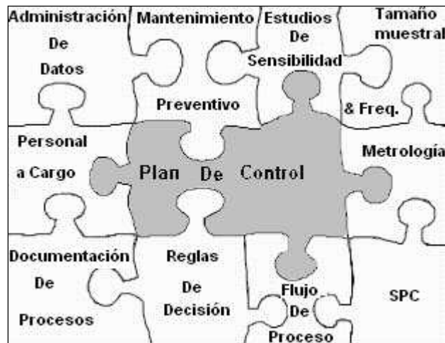
Figura 5. 8 Esquema representativo de elementos integrales (no siendo los únicos) de un plan de control de procesos.
