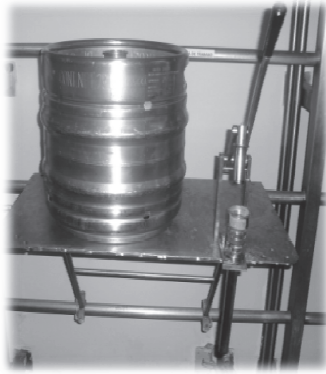
Ilustración 12: Mesa de trabajo para reparación de barril.
