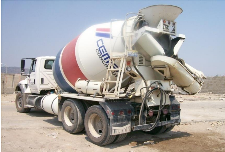
Fig. 2.4 Los camiones que transportan el concreto “trompos” lo mantienen en estado fresco gracias al mezclado continuo, descargándolo lejos de la planta.
