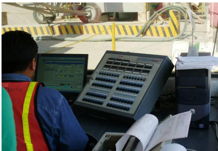
Fig. 2.6 Dosificación de materiales en función de su peso, para fabricar concreto premezclado.
