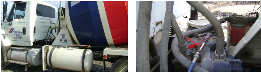
Figs. 5.1 y 5.2 Colocación de sellos en los camiones.
